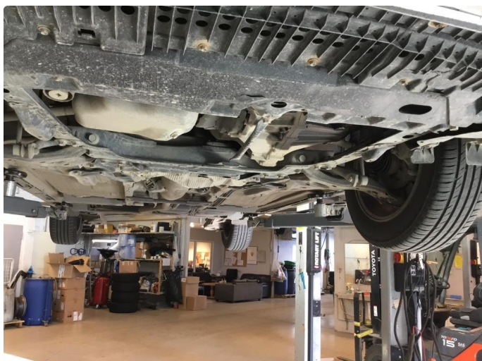
1.2 Beskyttelsesplate skadet/mangler under motor
