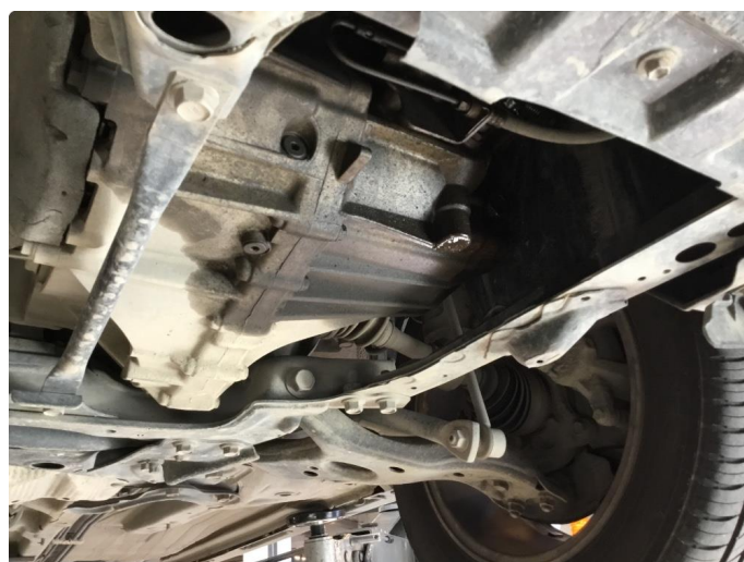
6.1 lekkasje tetting for girvelger. Girkasse. Henger dråper
