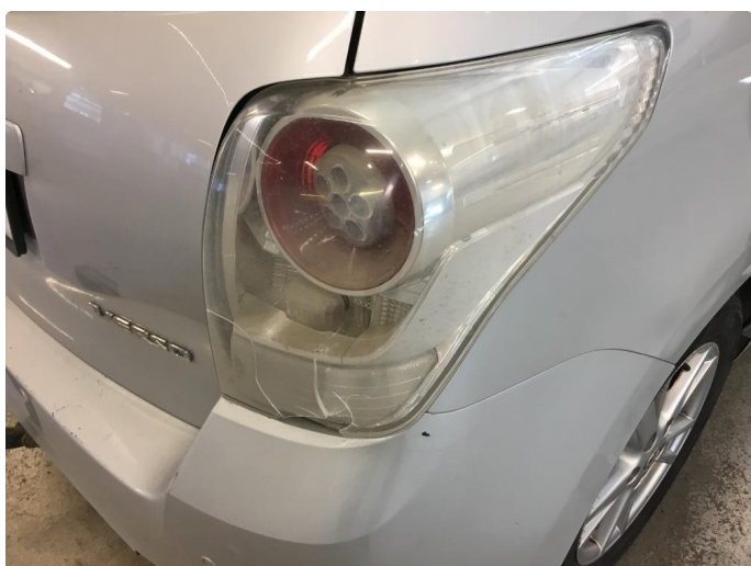
2.2 Defekt / sprukket glass, høyre baklykt
