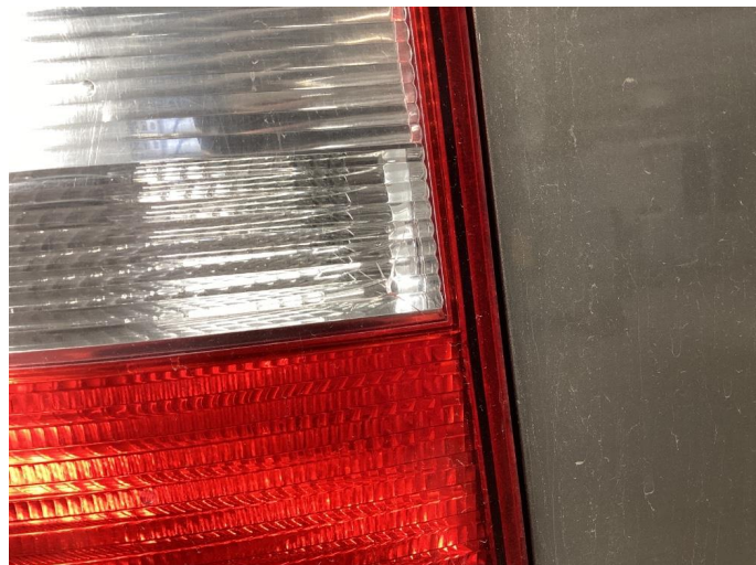
2.3 Defekt / sprukket glass
