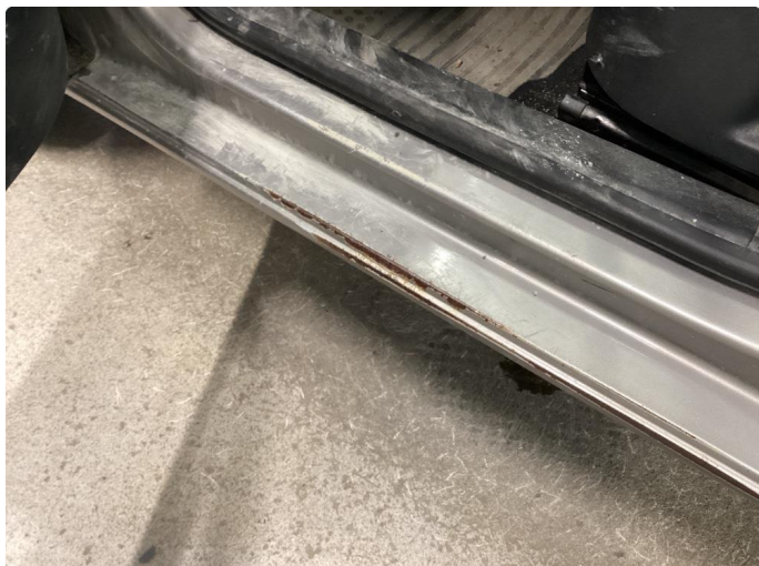
1.4 Slitt gjennom lakk
