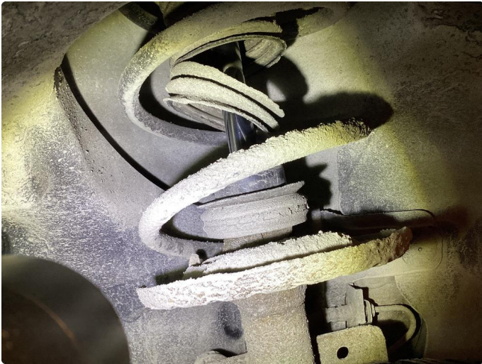
3.1 Støvmansjetter foran er mørken, dempere er ok.
