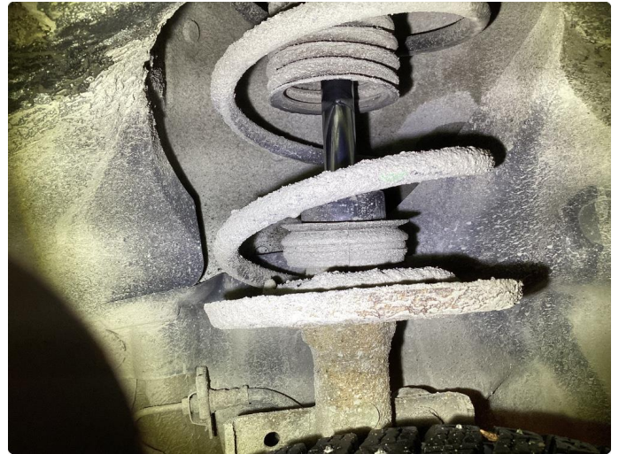
3.1 Støvmansjetter foran er mørken, dempere er ok.
