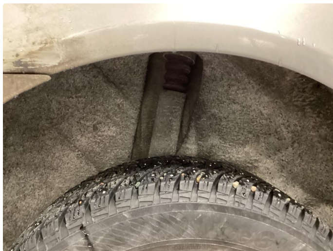
5.1 Støvkappe vesnstre bak er løsnet. Demper svetter. Bør byttes.
