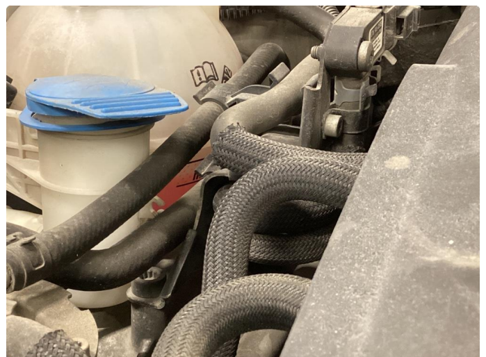
4.2 Kjøleveske på minimum. Ingen synlige lekkasjer
