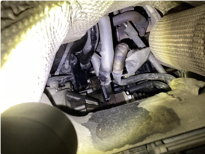
4.1 Oljelekkasje fra motor, området rundt topp.
