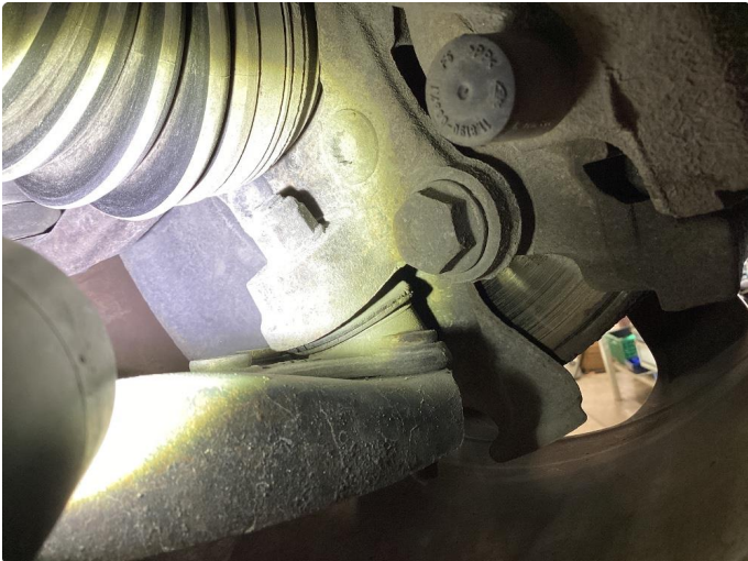
5.2 Slakk i bærekule, høyre foran. Mansjetter er morkne på begge sider .
