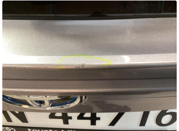
1.2 Ripe(r) ned til grunning
