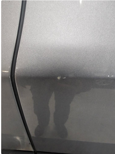
1.1 Bulk med lakkskade. Lakkskaden har blitt penslet
