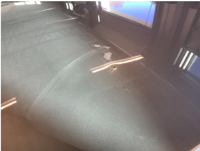
1.1 Steinsprut med rust
