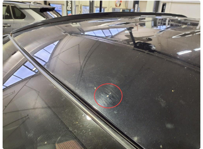
1.2 Steinsprut med rust
