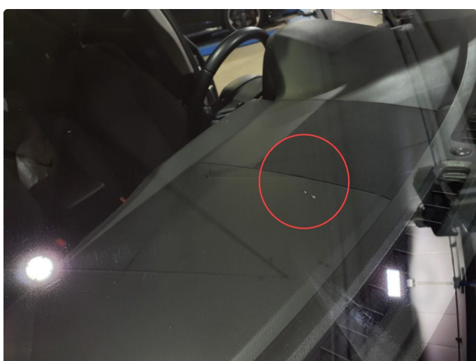
1.5 Steinsprut med sprek (blir byttet front rute)
