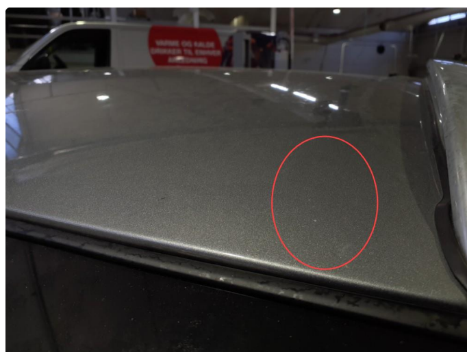
1.4 Steinsprut - denne er utbedret med lakk
