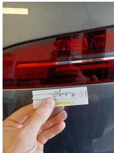
2.1 Noe krakelering i baklykter.
