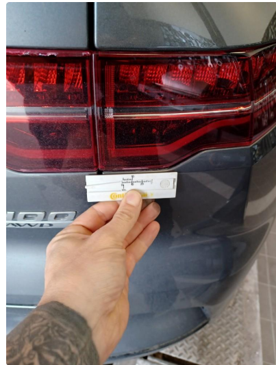
2.1 Noe krakelering i baklykter.
