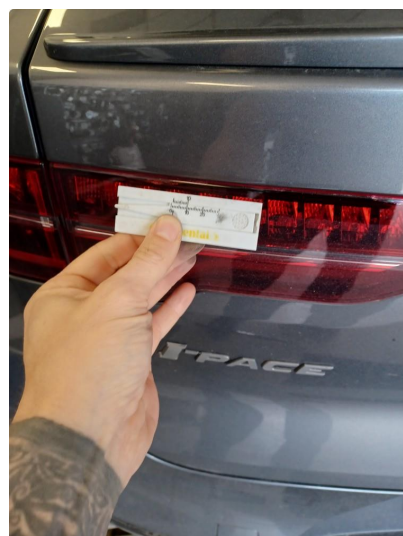
2.1 Noe krakelering i baklykter.
