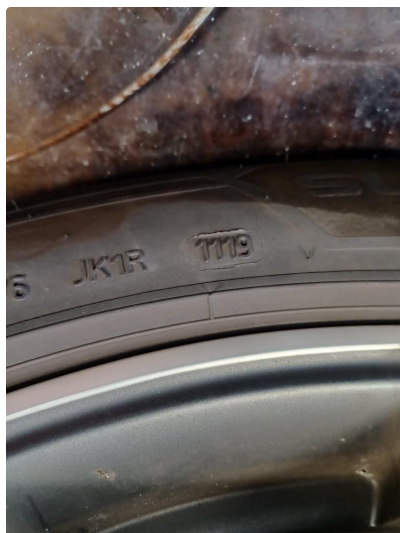
4.1 -Sommerdekk ca 3,5mm igjen (prod:uke 11 år 19) Ingen ytre påvirkning på felger.OK -Vinterfelger lokalisert på mobil dekkhotell som åpner igjen til høsten. Tilstand vites ikke ved takst.
