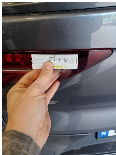
2.1 Noe krakelering i baklykter.
