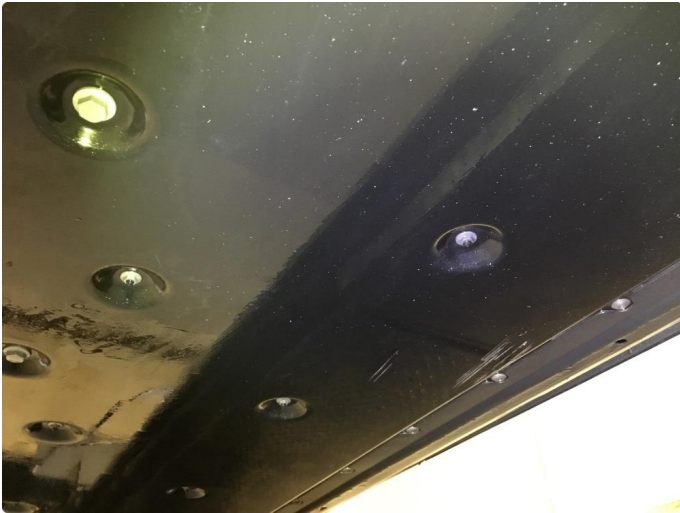
1.1 Skrapeskade plate under batteri venstre side midt på bilen. (Ikke bulket )
