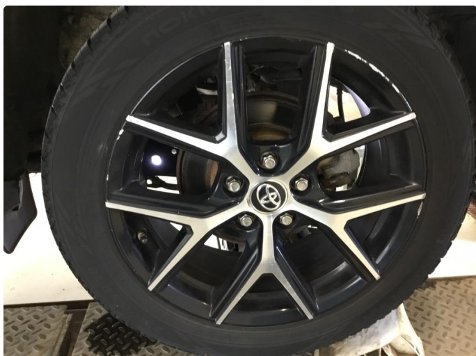
1.2 Noe skrapeskader felger. Normal bruksslitasje.
