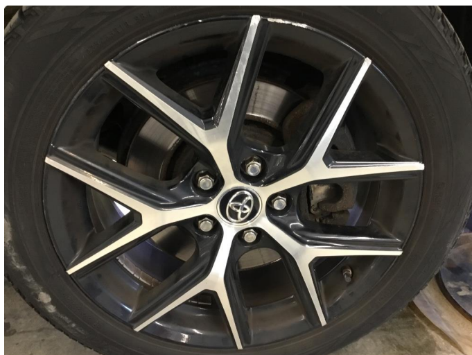
1.2 Noe skrapeskader felger. Normal bruksslitasje.
