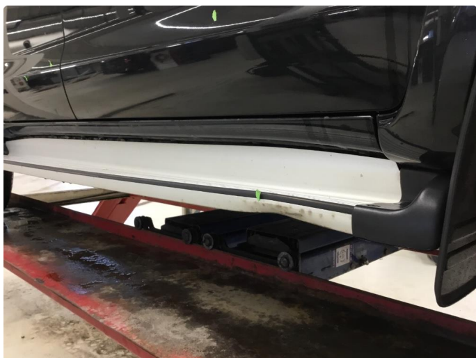
1.9 Bulket stigtrinn høyre foran.
