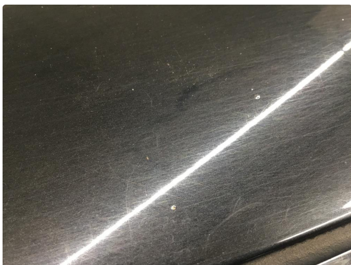
1.2 Noe steinsprut m/rustutslag panser.
