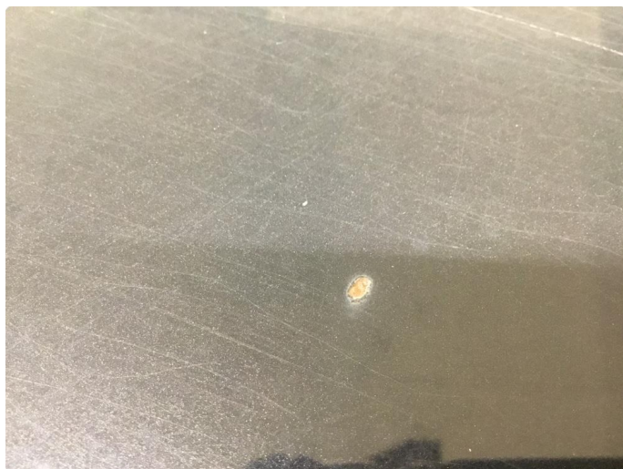
1.2 Noe steinsprut m/rustutslag panser.
