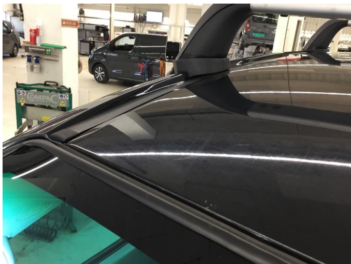
1.7 Steinsprut med rustutslag tak. Noe i kanten mot rute.
