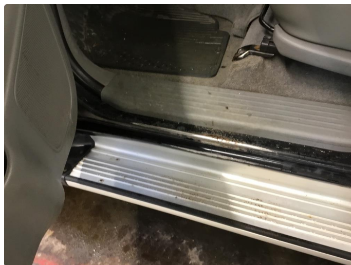
1.5 Lakk slitt bort innsteg førerside.
