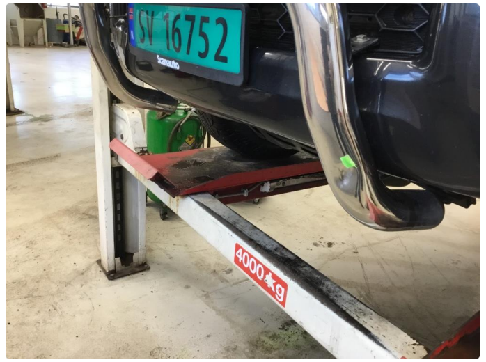
4.1 Frontbøyle bulket v.side.
