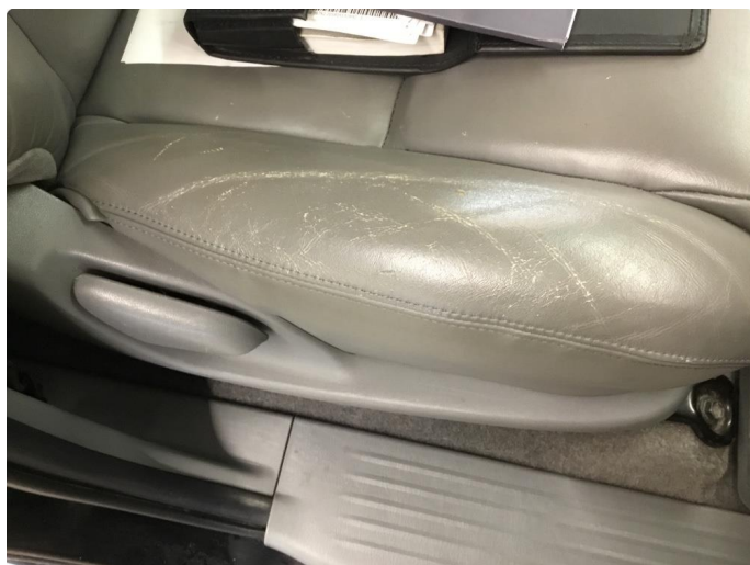
3.1 Slitt/hull setetrekk fører sete. Noe slitt i kanten passasjer sete
