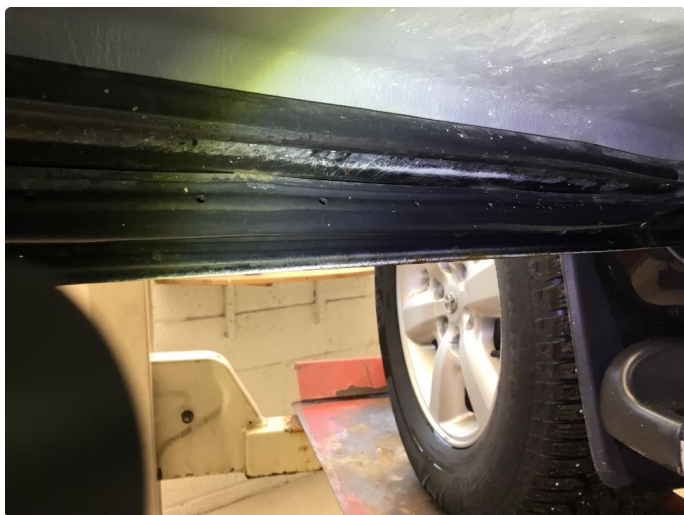
1.3 Litt slitt lakk/noe rust i bunn førerdøren. Mye rust i bunn h.bakdør.
