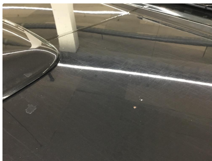
1.2 Noe steinsprut m/rustutslag panser.
