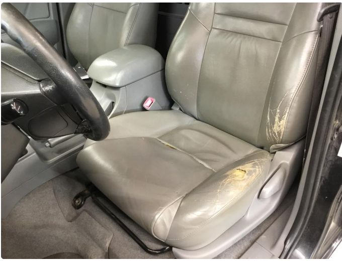
3.1 Slitt/hull setetrekk fører sete. Noe slitt i kanten passasjer sete
