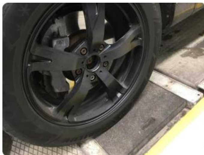
1.1 Normal bruksslittasje på lakk
