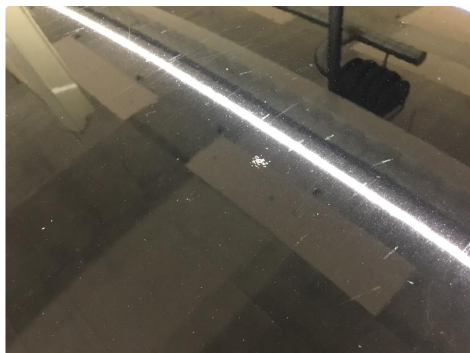
1.3 Noe steinsprut m/rustutslag på taket.
