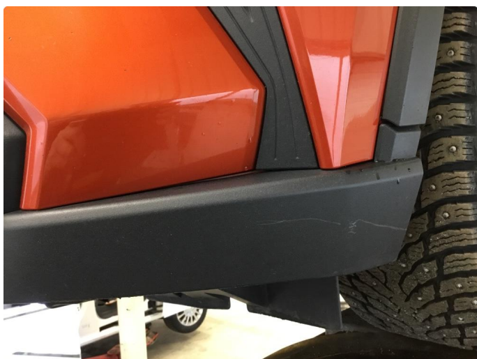
1.2 Noe svake riper i plast nede v.hjørne fanger foran. Bruksslitasje.
