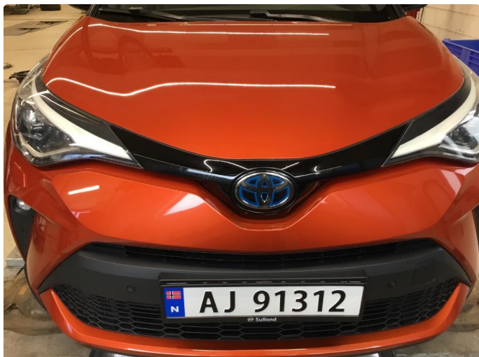
1.1 Noe steinsprut front/panser. Normal bruksslitasje.
