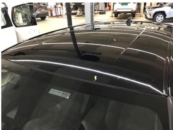
1.3 Noe steinsprut m/rustutslag på taket.
