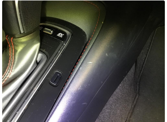
1.2 Skifte konsoll rundt ladeplate/midtkonsoll. Er bestilt, blir skiftet når ankommet.
