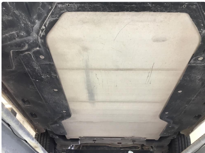
2.1 Langsgående riper plate under batteri. Ikke skadet/ikke bulket. Kun kosmetisk.
