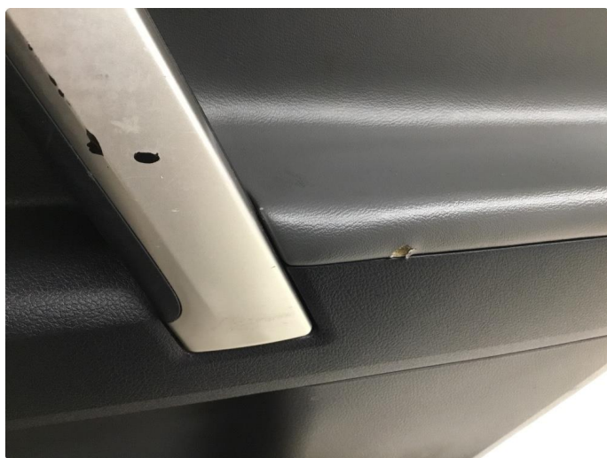
2.2 Noe merker/skader dørtrekk.
