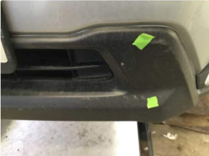
1.1 Noe riper på det svarte i fanger foran.
