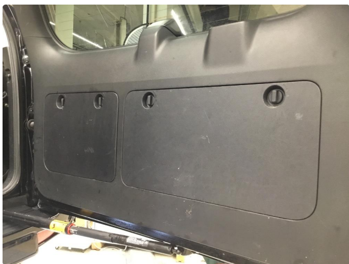
1.1 Noe bruksslitasje dørtrekk begge sider bak og bak i varerom.
