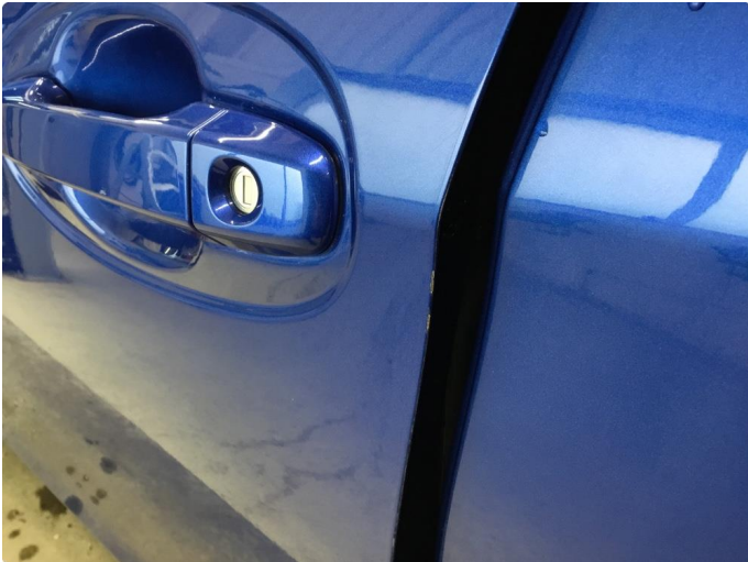
1.1 Noe skrapeskader/steinsprut/Bruksslitasje. Penselflekket.
