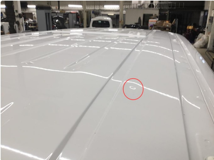
1.1 Liten bulk i tak uten lakkskade.
