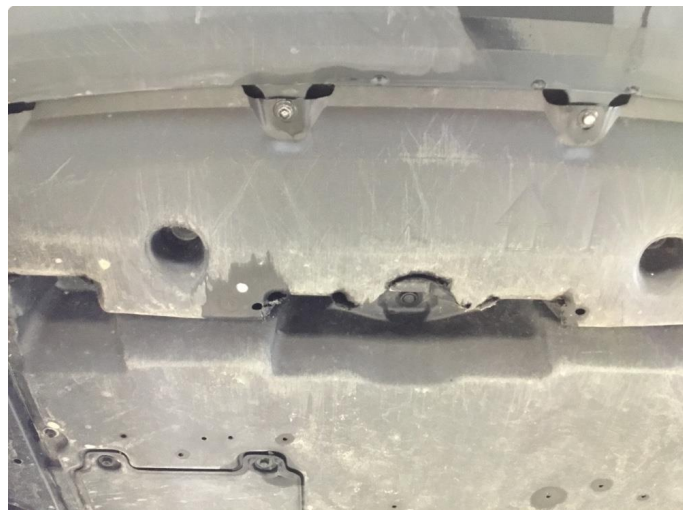
1.2 Subbeskade på beskyttelsesplate under mot fanger foran.
