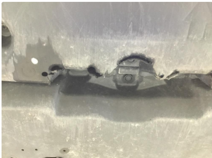
1.2 Subbeskade på beskyttelsesplate under mot fanger foran.
