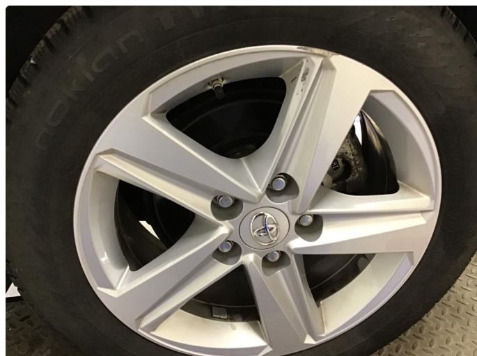
1.1 Noe kantkjørte vinterfelger.
