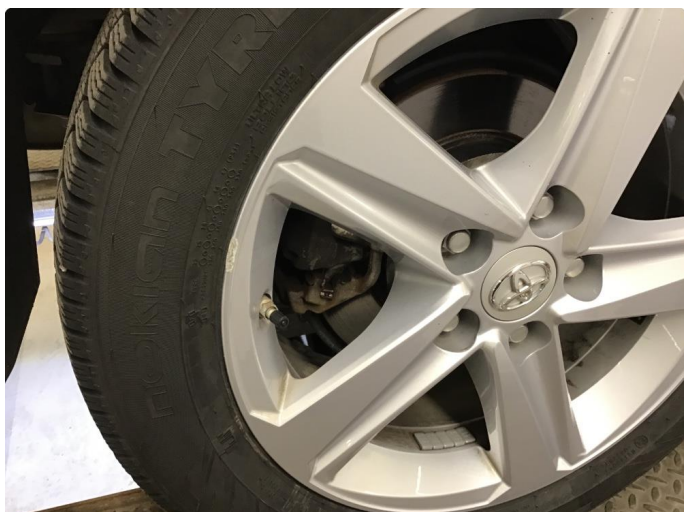
1.1 Noe kantkjørte vinterfelger.
