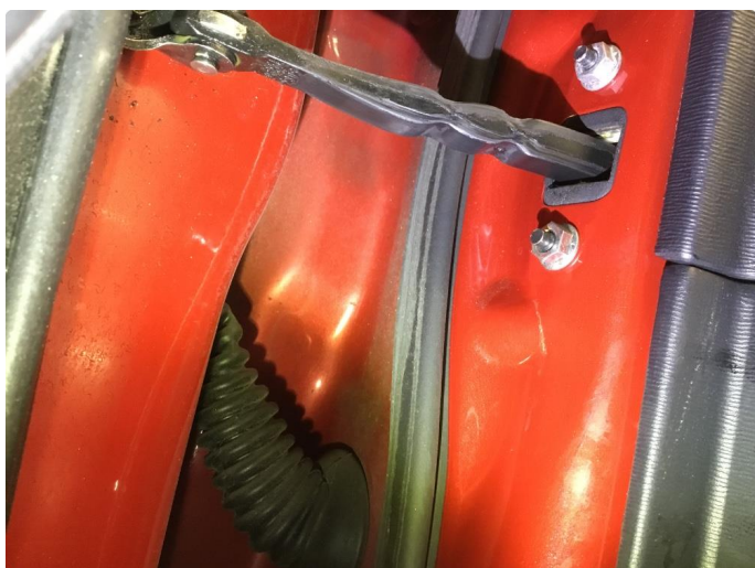
1.2 Sprekker rundt innfesting dørstopper v.foran, samt antydning til sprekker høyre foran.
