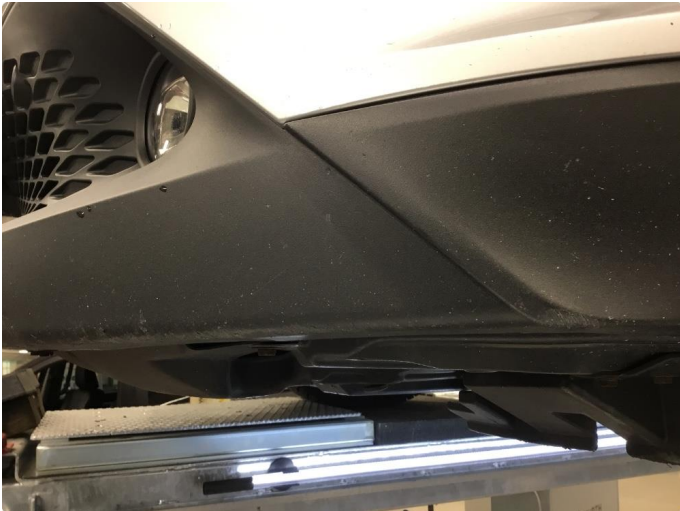
1.2 Noe subbesriper underkant svart plast fanger foran v.side. Norm.bruksslitasje.
