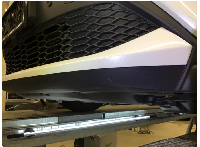
1.1 Noe subberiper oppunder svart plast nedkant fanger foran. Normal bruksslitasje.
