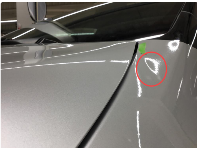
1.2 Liten klemskade v.forskjerm, oppe i bakkant.
