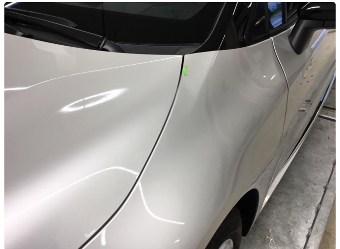
1.2 Liten klemskade v.forskjerm, oppe i bakkant.
