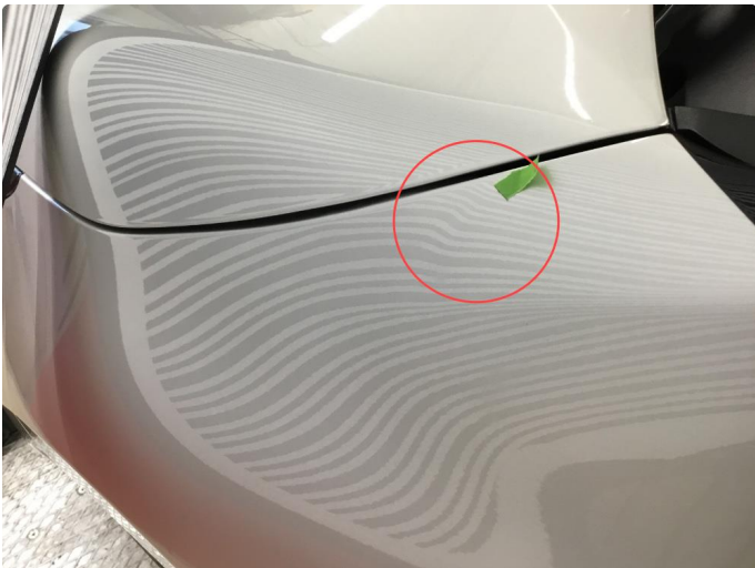
1.2 Liten klemskade v.forskjerm, oppe i bakkant.
