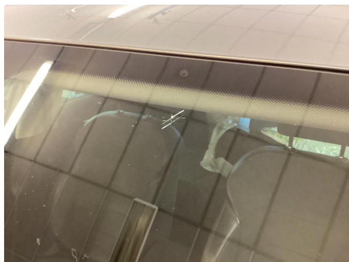
1.2 Steinsprut med sprekk
