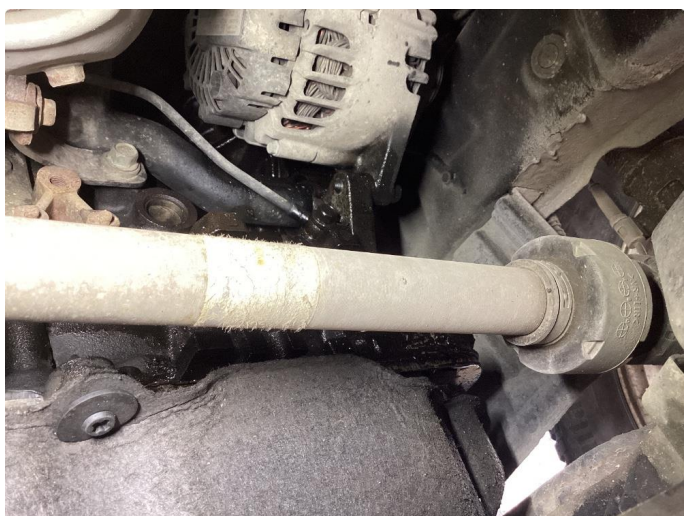
3.3 Oljelekkasje fra motor
