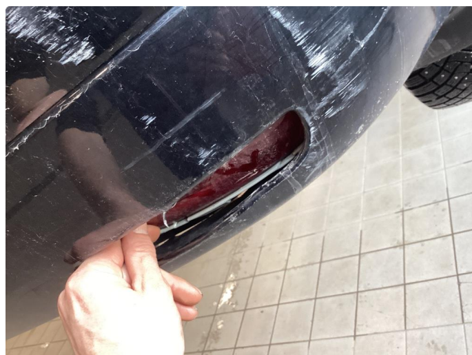
2.1 Tåkelys - defekt/sprukket glass
