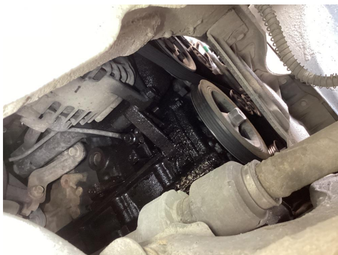
3.3 Oljelekkasje fra motor
