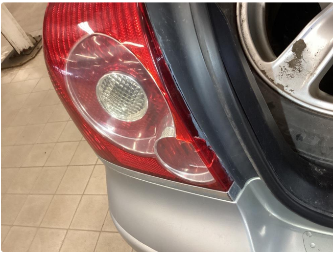
2.3 Defekt / sprukket glass
