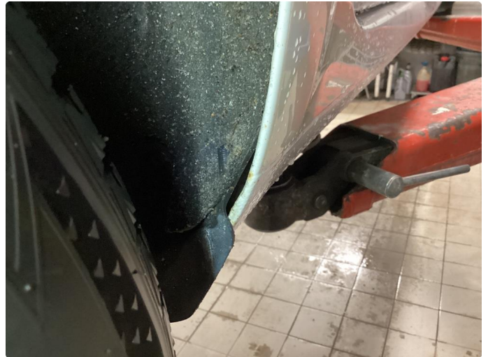
1.2 Steinsprut med rust
