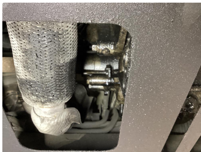
2.1 Oljelekkasje fra motor
