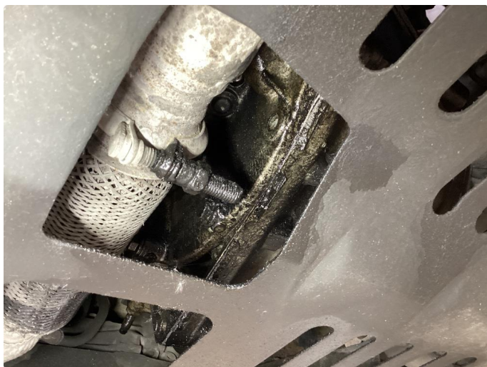
2.1 Oljelekkasje fra motor
