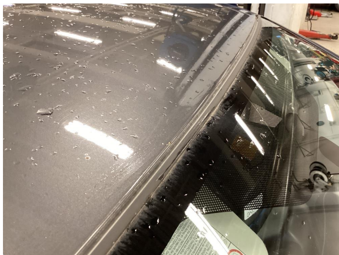
2.7 Steinsprut med rust
