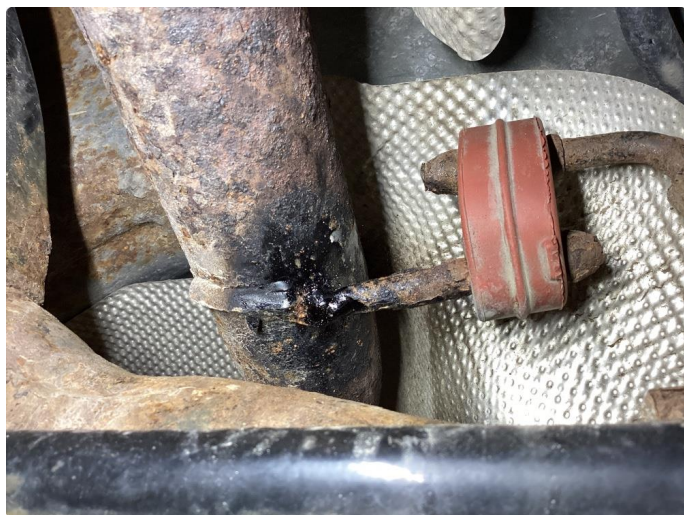
3.3 Eksosrør innfestning defekt/mangler
