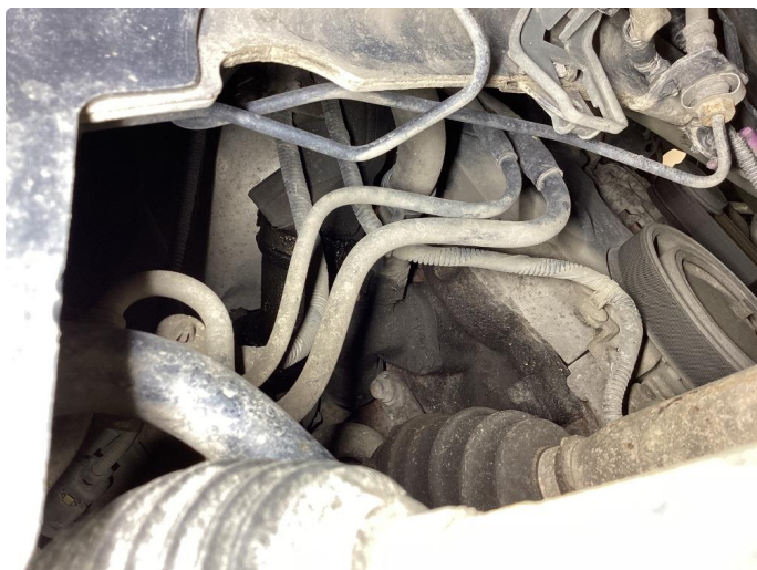
3.4 Oljelekkasje fra motor
