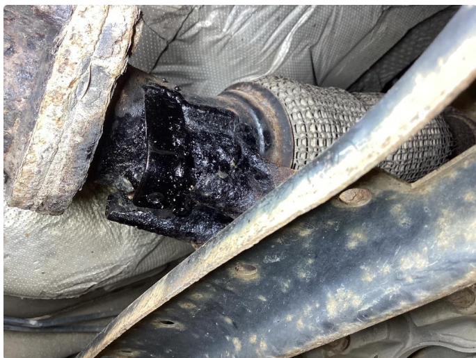
3.2 Eksosrør innfestning defekt/mangler
