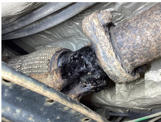
3.2 Eksosrør innfestning defekt/mangler
