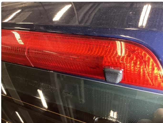
2.1 Defekt / sprukket glass
