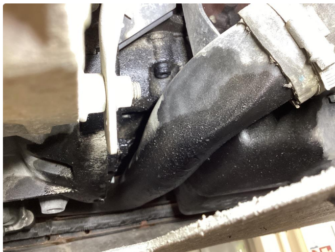
3.4 Oljelekkasje fra motor
