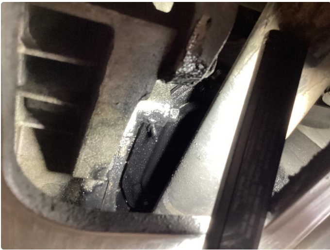
3.2 Oljelekkasje fra motor
