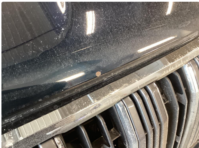
2.1 Noe steinsprut med rust
