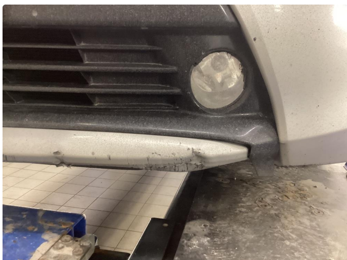
1.4 Ripe(r) ned til grunning
