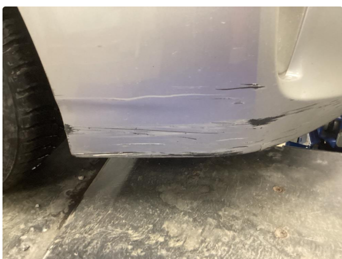
1.4 Ripe(r) ned til grunning
