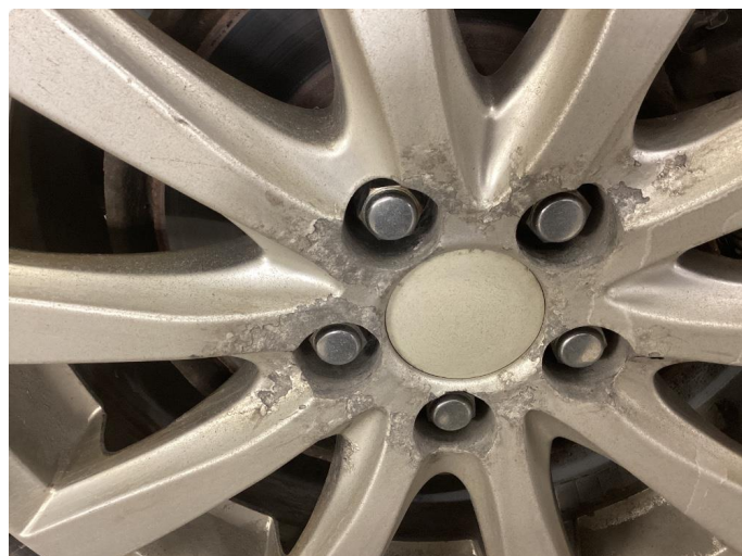
1.4 Ripe(r) ned til grunning
