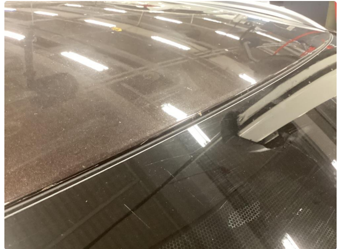
1.2 Steinsprut med rust
