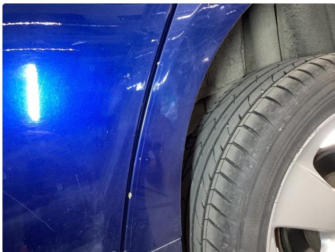
1.4 Steinsprut med rust
