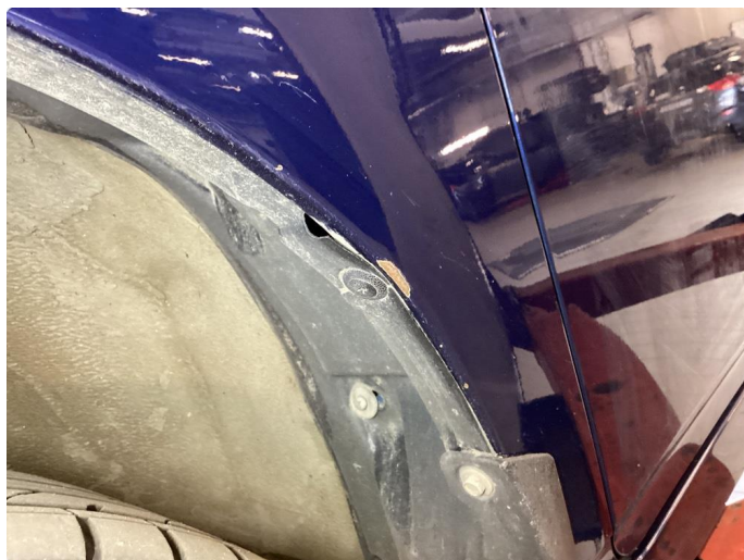
1.4 Steinsprut med rust
