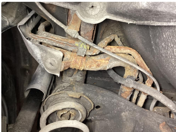
3.1 Rust på drivstoffrør
