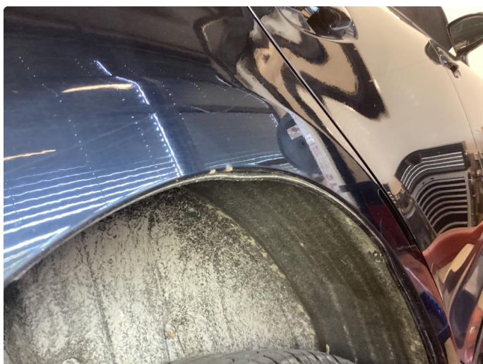
1.6 Steinsprut med rust
