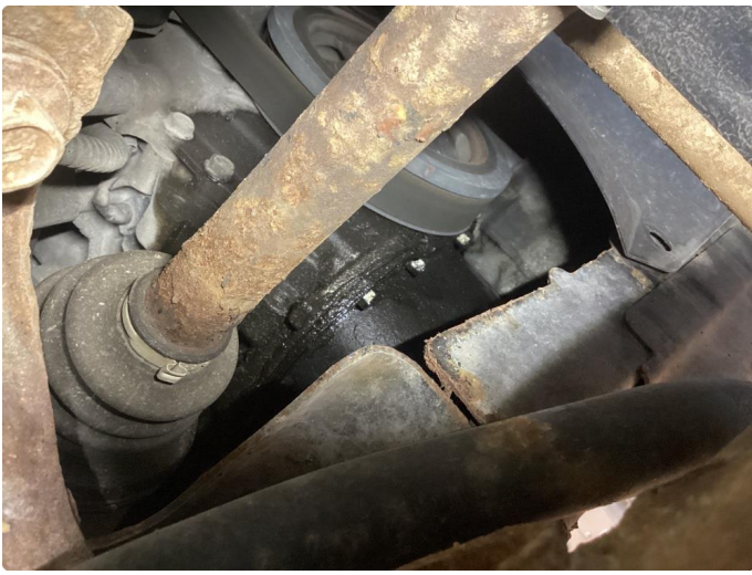
2.2 Oljelekkasje fra motor
