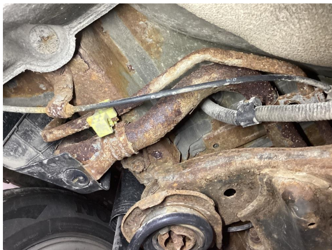
2.1 Rust på drivstoffrør
