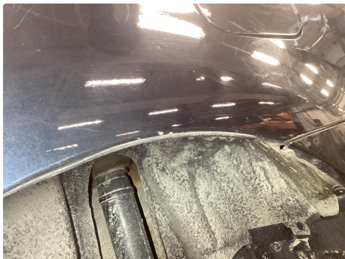
1.6 Steinsprut med rust
