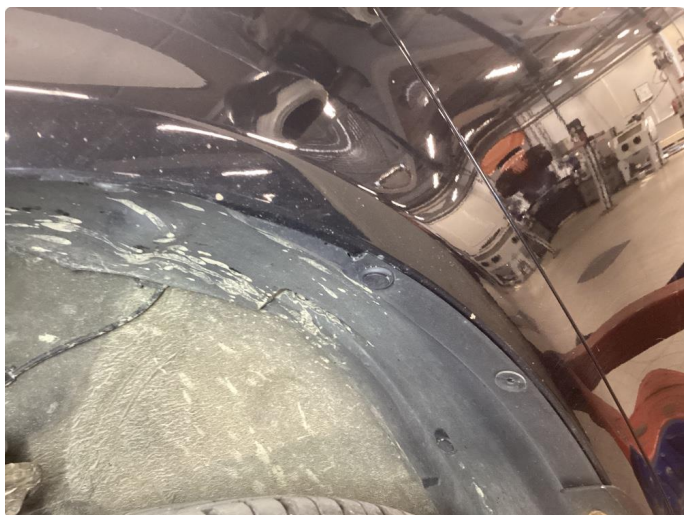
1.6 Steinsprut med rust
