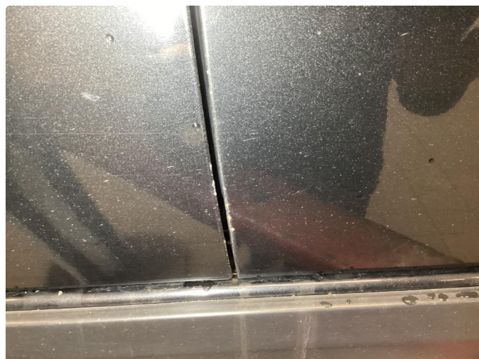
1.2 Steinsprut med rust
