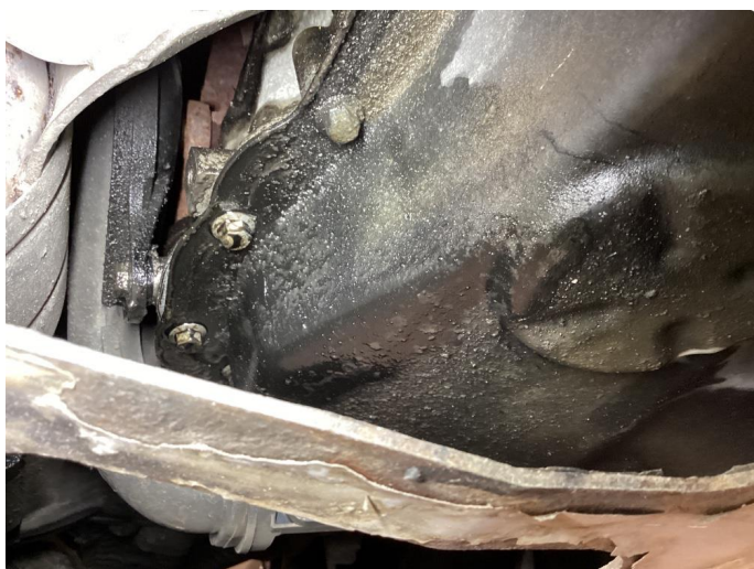
3.1 Oljelekkasje fra motor
