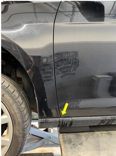
1.1 Korrosjon framdør venstre
