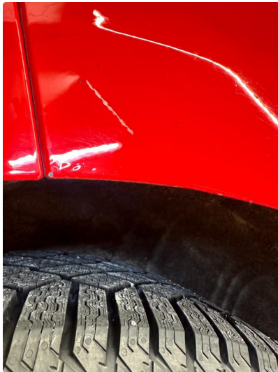
1.2 Korosjon hjulbue høyre bak.
