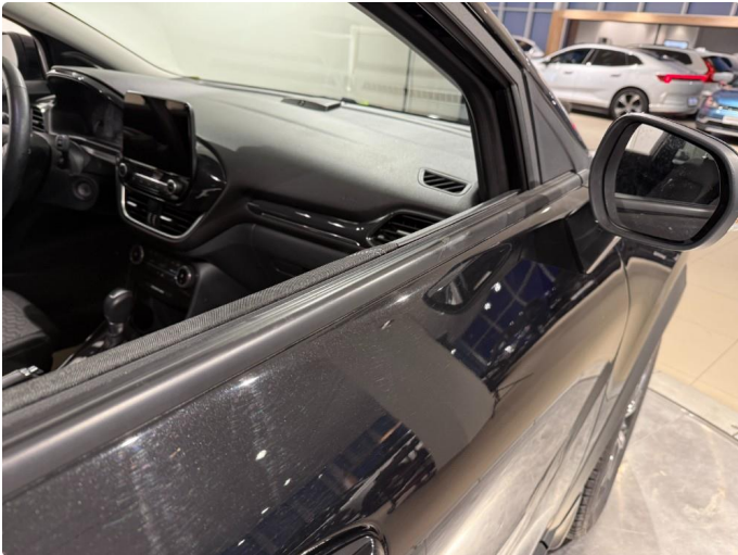
1.1 Riper/hakk vinduslist høyre foran.
