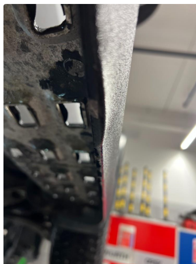
1.3 Lakk/folie stigtrinn begge sider har begynt å slippe.
