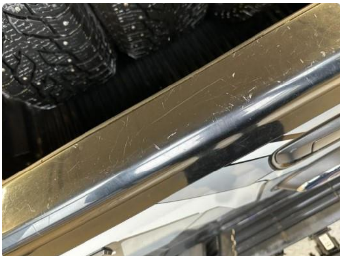
1.1 Små bulker og riper overkant bakluke.
